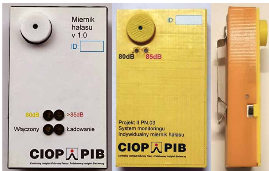
Rys. 5. Indywidualny miernik hałasu: w wersji pierwszej – po lewej, w wersji końcowej – po prawej; widok z góry i z boku (fot. Leszek Morzyński)
