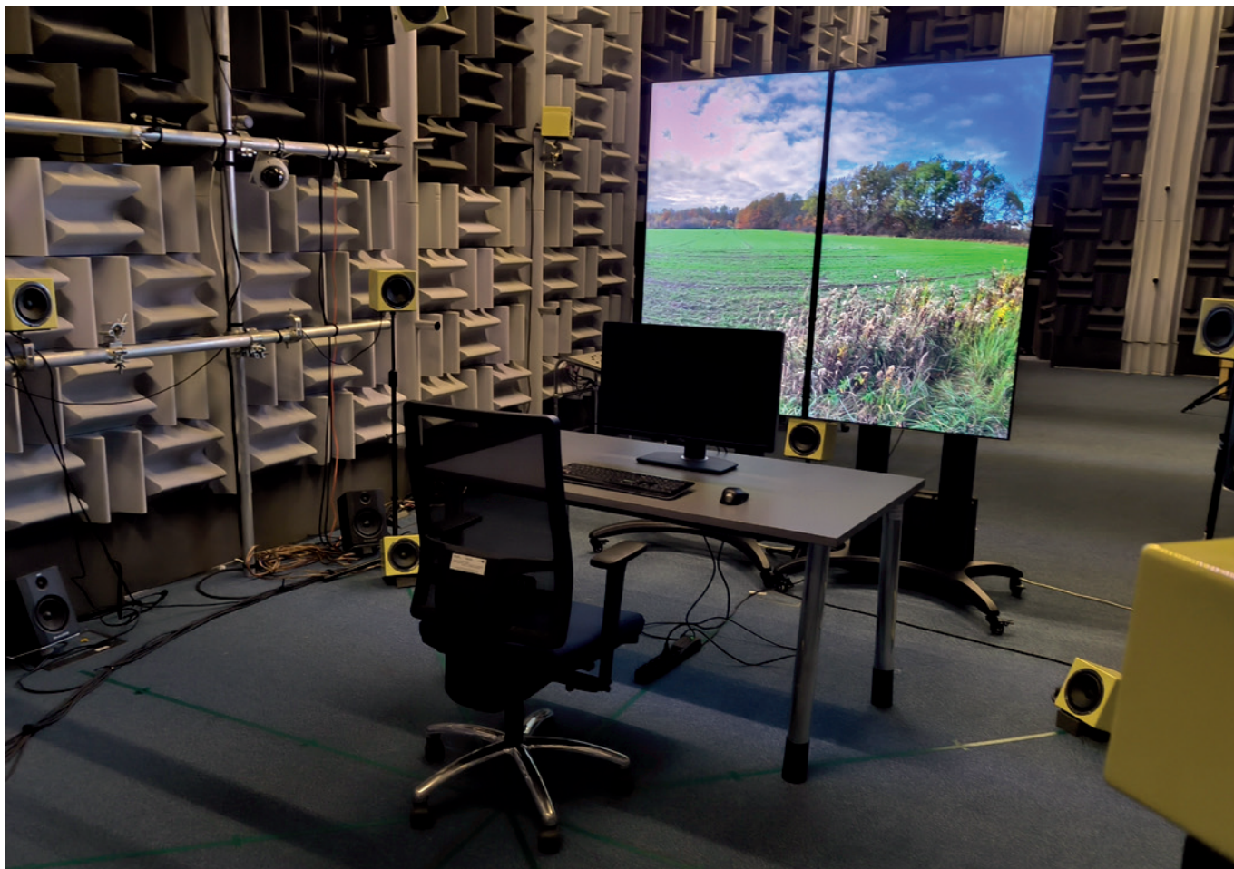
Fot. 2. Stanowisko badawcze do odtwarzania dźwięku przestrzennego (fot. Leszek Morzyński) Photo 2. Research stand for spatial sound reproduction (photo: Leszek Morzyński)
